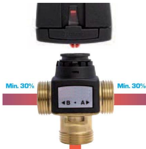
Wenn der Stellmotor entfernt wird, herrscht in beiden Kreisläufen gleichmäßiger Durchfluss
